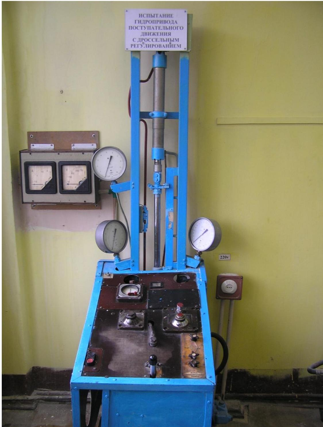
Рис. 2.15. Общий вид лабораторной установки для испытания гидропривода с дроссельным регулированием и выходным звеном поступательного движения
