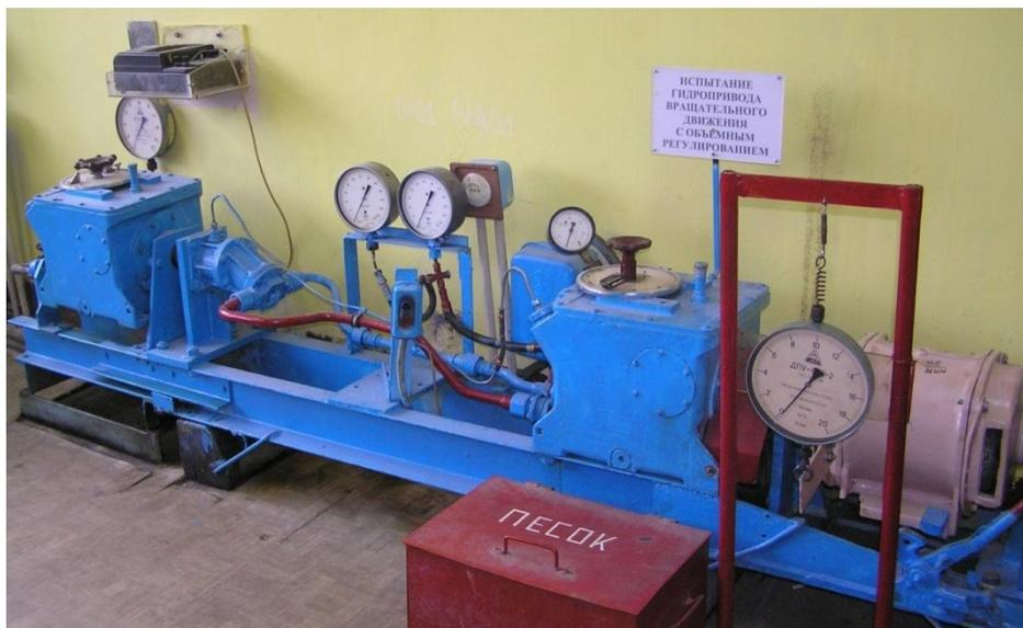
Рис. 2.7. Общий вид лабораторной установки для испытания гидропривода с выходным звеном вращательного движения
