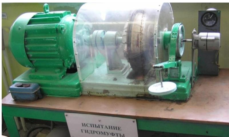
Рис. 2.23. Общий вид лабораторной установки для испытания гидромуфты
