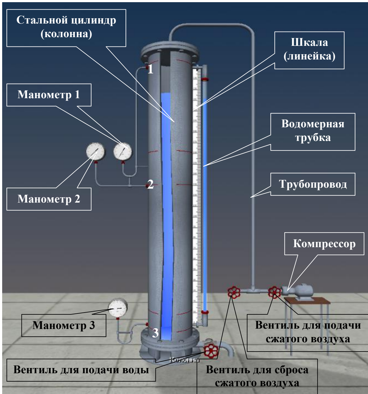
Рис. 1. Схема установки для экспериментального подтверждения основного уравнения гидростатики и закона Паскаля
