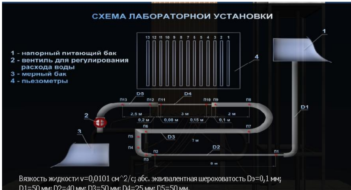
Рис. 11. Схема установки для изучения гидравлических сопротивлений
