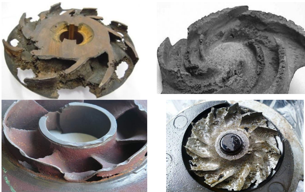
Рис. 46. Разрушение рабочих колес насосов вследствие кавитации
